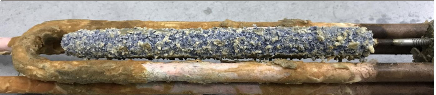
Состояние ТЭНа после 3 недели испытаний
